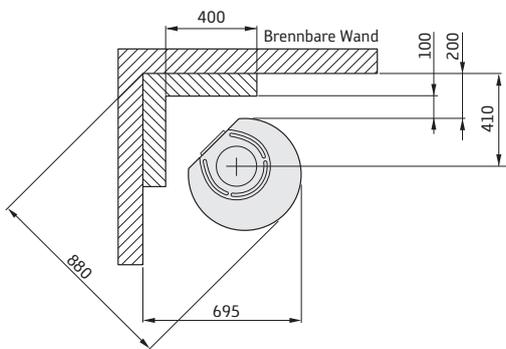
Für brennbare Baubestandteile zugelassener Bereich
