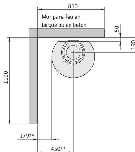
\* Si le poêle est placé sur une plaque de sol en verre par exemple (en option), la hauteur à partir du sol est modifiée d'une valeur correspondant à l'épaisseur de la plaque de sol (10 mm pour une plaque de sol indépendante en verre).
