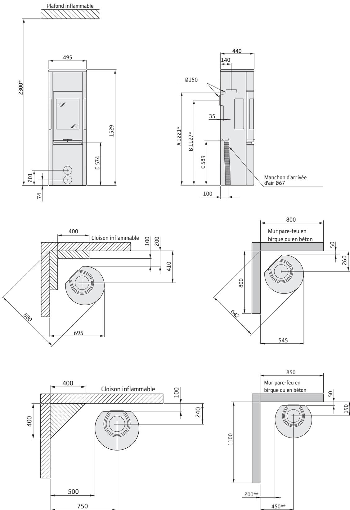
\* Si le poêle est placé sur une plaque de sol en verre par exemple (en option), la hauteur à partir du sol est modifiée d'une valeur correspondant à l'épaisseur de la plaque de sol (10 mm pour une plaque de sol indépendante en verre).
