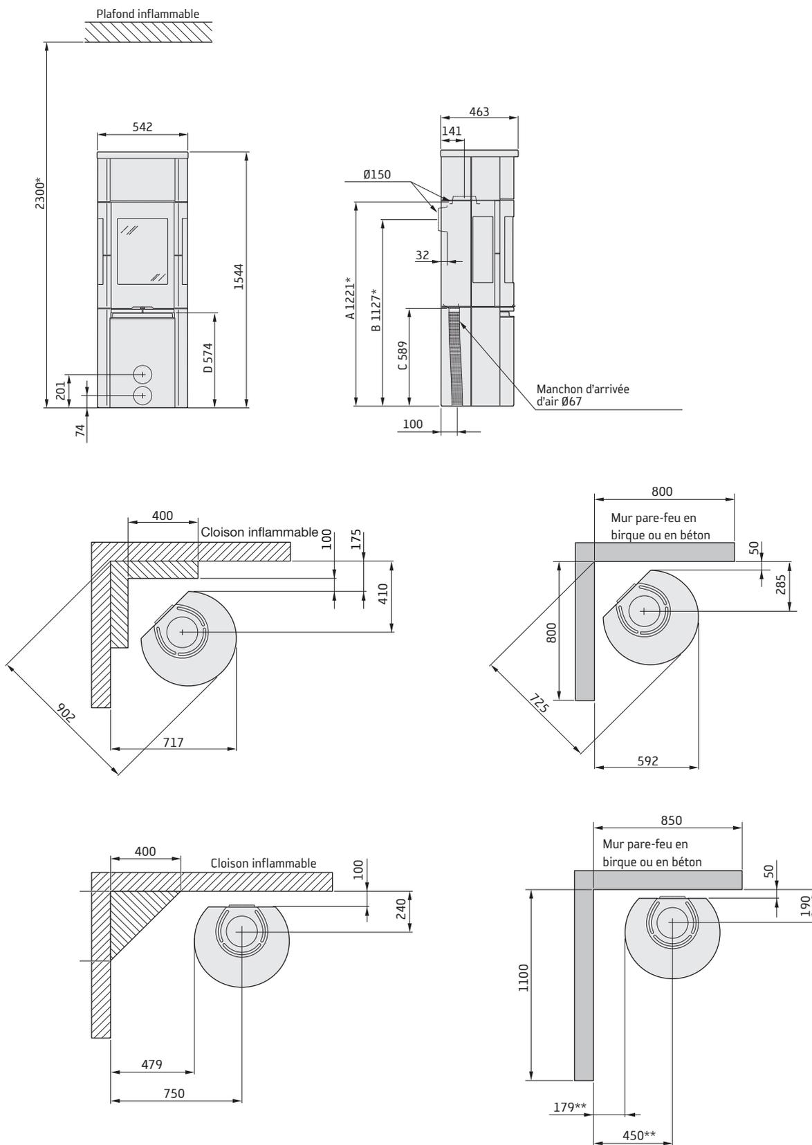
\* Si le poêle est placé sur une plaque de sol en verre par exemple (en option), la hauteur à partir du sol est modifiée d'une valeur correspondant à l'épaisseur de la plaque de sol (10 mm pour une plaque de sol indépendante en verre).
