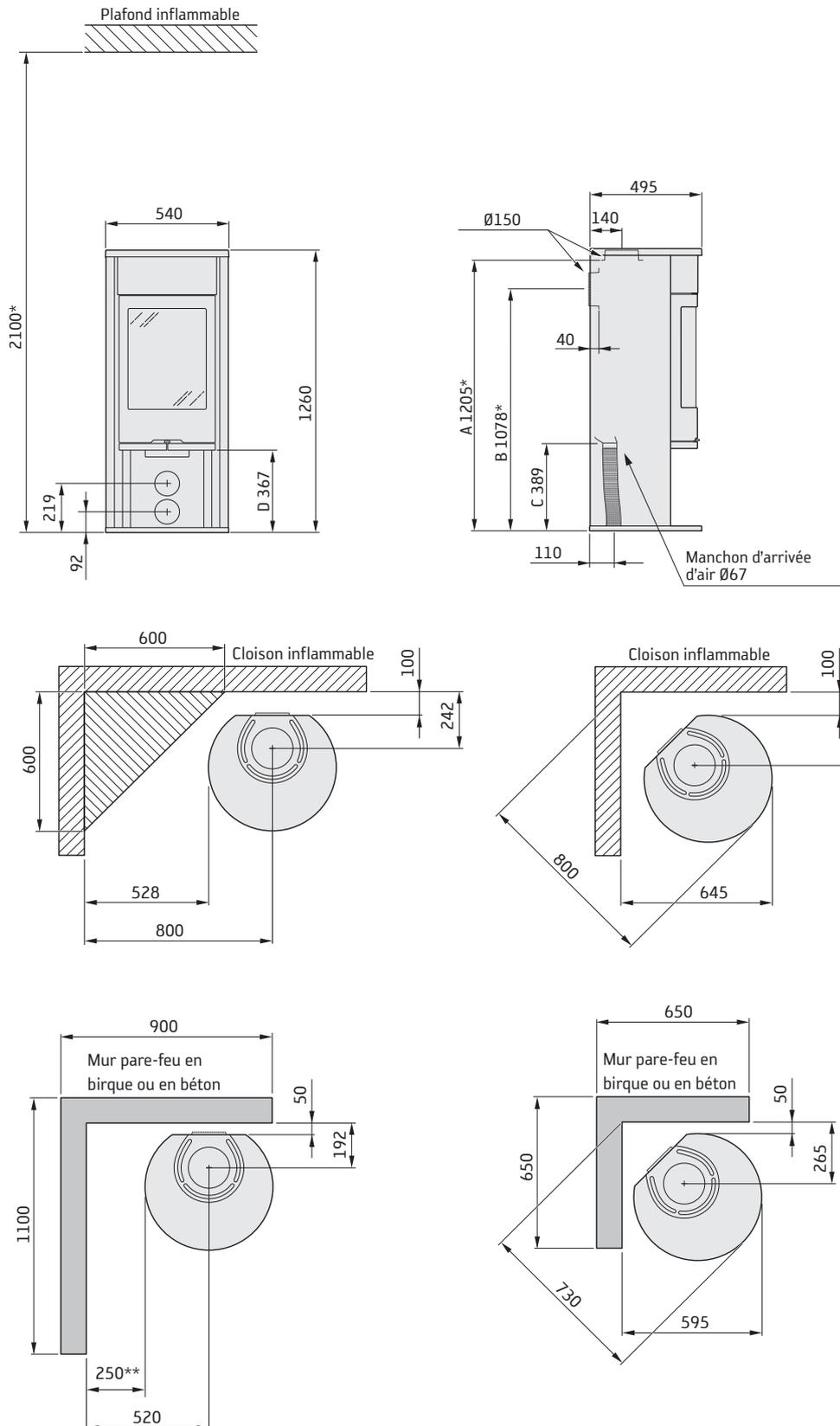
\* Si le poêle est placé sur une plaque de sol en verre par exemple (en option), la hauteur à partir du sol est modifiée d'une valeur correspondant à l'épaisseur de la plaque de sol (10 mm pour une plaque de sol indépendante en verre).
