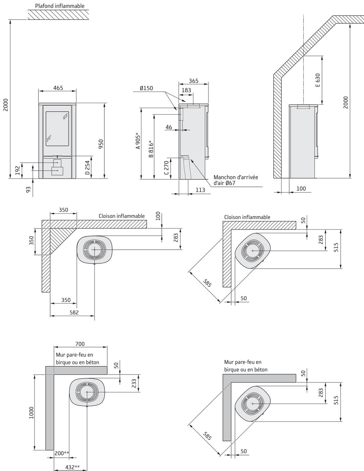
\* Si le poêle est placé sur une plaque de sol en verre par exemple (en option), la hauteur à partir du sol est modifiée d'une valeur correspondant à l'épaisseur de la plaque de sol (10 mm pour une plaque de sol indépendante en verre).
