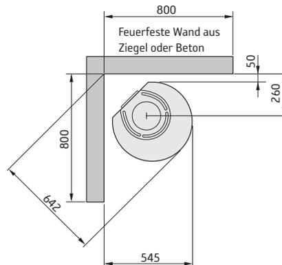
Für brennbare Baubestandteile zugelassener Bereich
