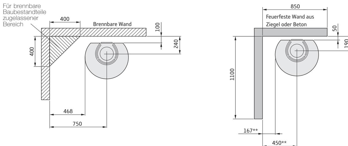
\* Wenn der Kaminofen auf einem Brandschutzbereich z.B. aus Glas (Zubehör) aufgestellt wird, ändert sich die Höhe vom Boden um die Stärke des Brandschutzbereichs. Ein freiliegender Brandschutzbereich aus Glas macht 10 mm aus.
